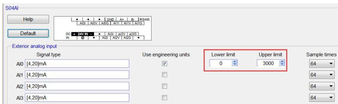
Аналогично, для аналогового выхода установим нижнее предельное значение 0, соответствующее 0,0 Гц, верхнее предельное значение 500, соответствующее 50,0 Гц и, если необходимо, чтобы выходная частота ПЧ составляла 25,6 Гц, принудительно установим значение AQ0 как 256, чтобы вывести значение AQ0, равное 256. Как показано ниже:
