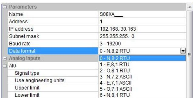
В настройках внешнего аналогового входа можно установить тип сигнала каждого канала, выбрать, использовать ли инженерное значение или нет, верхний и нижний пределы инженерного значения (его можно установить, если вы проверите необходимость использования инженерного значения), частоту дискретизации и коррекцию нуля.
